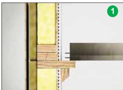
Pose des poutrelles sur corbeaux
