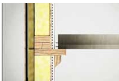
Pose des Poutrelles sur corbeaux
