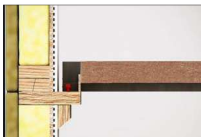
Les connecteurs assurent la liaison mécanique
