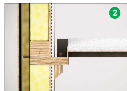
Mise en oeuvre du hourdis Seacbois
