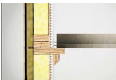
Pose des Poutrelles sur corbeaux
