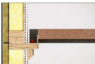
Les connecteurs assurent la liaison mécanique
