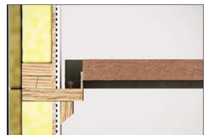
Mise en oeuvre du hourdis EBS
