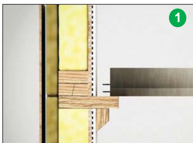
Pose des poutrelles sur corbeaux
