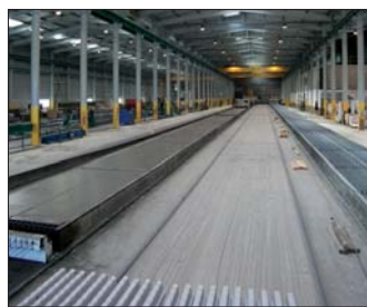
Fabrication Poutrelle TB
