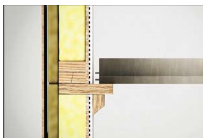
Pose des Poutrelles sur corbeaux
