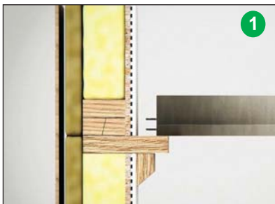
Pose des poutrelles sur corbeaux
