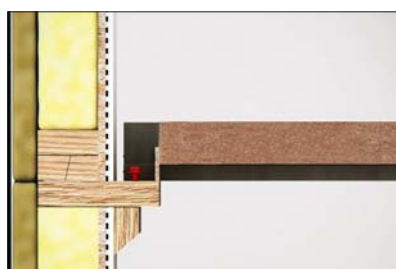
Les connecteurs assurent la liaison mécanique
