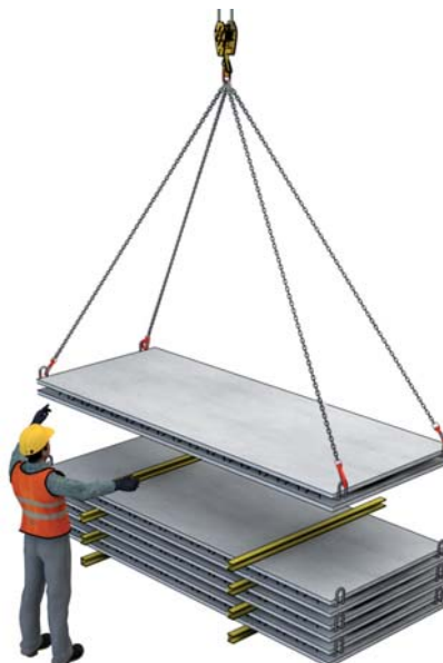
UTILISATION DE QUATRE CROCHETS DE LEVAGE
