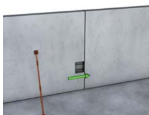
4 Ripage des armatures de liaison dans le prémur 2.
